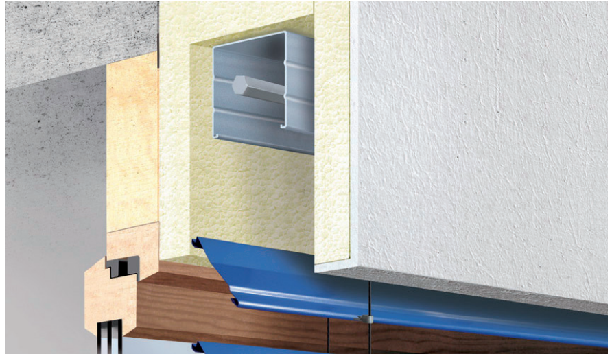
Coupe horizontale pour commande par treuil
